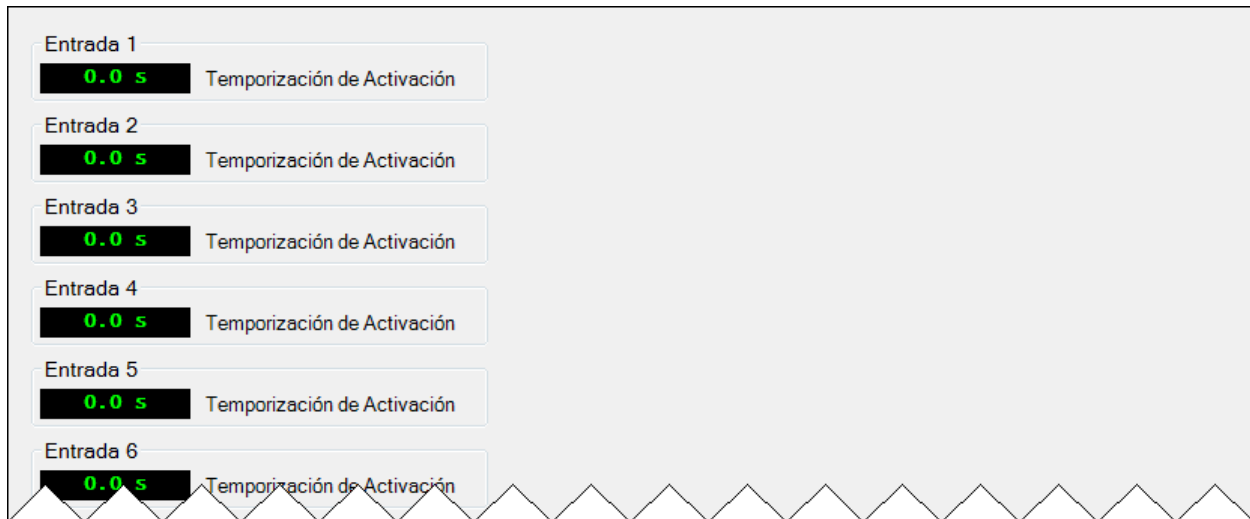
Figura 3-9. Temporizadores de entradas de contactos
