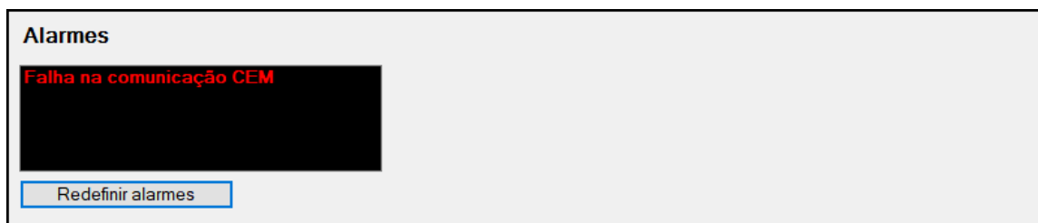
Figura 13-19. Tela de sinalização e redefinição de alarmes do DECS-250
