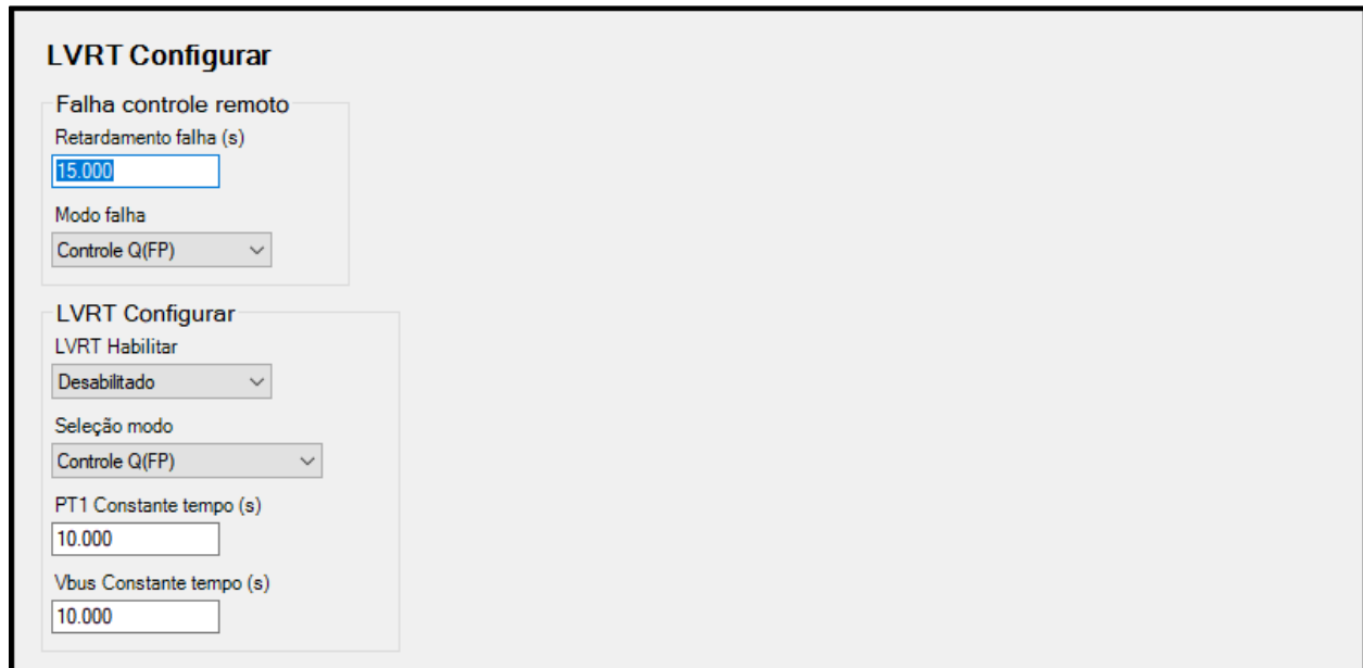
Figura 12-7. Controle de potência reativa, Tela configurar LVRT
