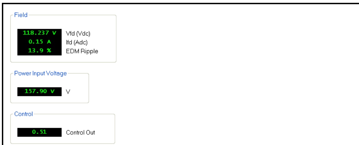
图 13-6. 励磁初始值测量
