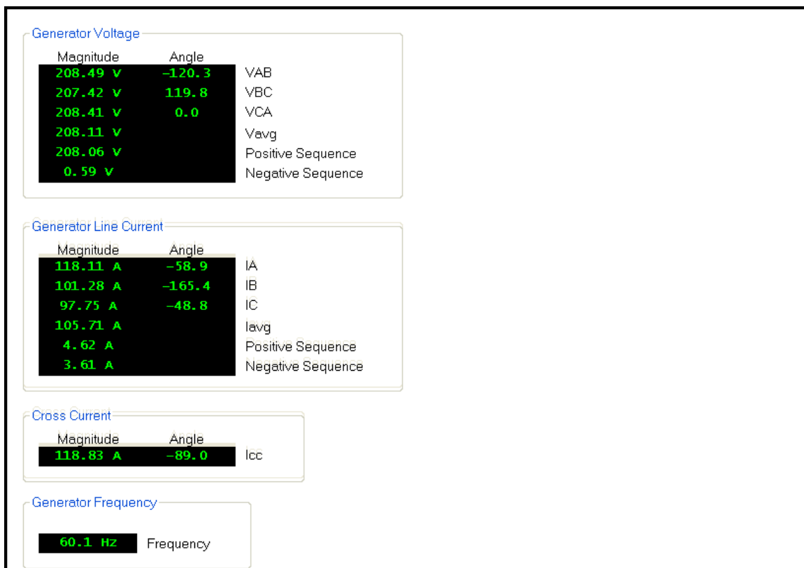
图 13-2. 发电机初始值测量
