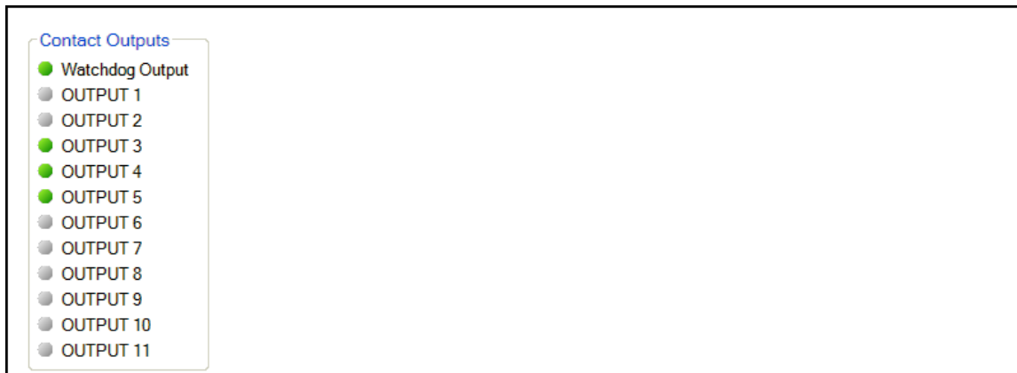
图 13-15. DECS-250 触点输出状态显示屏幕
