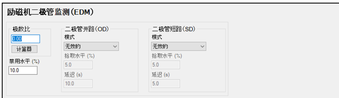
图 10-14. 励磁机二极管监控保护设置
