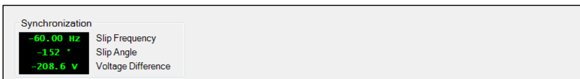
Figure 11-8. Mesures des valeurs primaires de synchronisation
