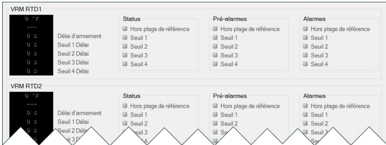
Figure 3-24. Explorateur des mesures, Entrées, Module régulateur de tension, écran Entrées RTD VRM
