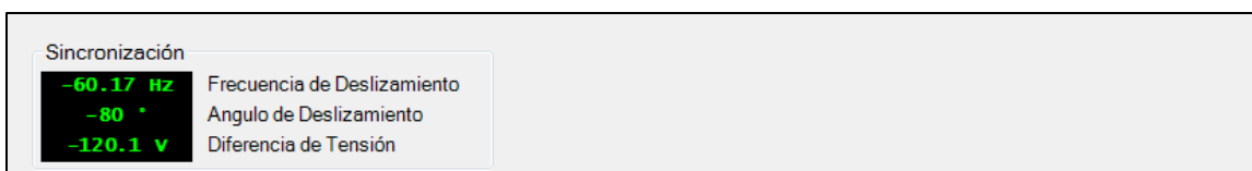
Figura 11-8. Medición de valores primarios de sincronización
