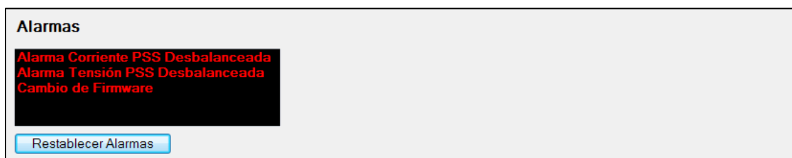
Figura 11-19. DECS-150 Pantalla de restauración y anuncio de la alarma
